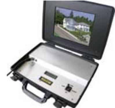
Zentrale Steuereinheit mit Tageslicht-Flachbildmonitor zum Steuern des Schwenk- und Neigekopfs und des Kamera-Zooms vom Boden aus
